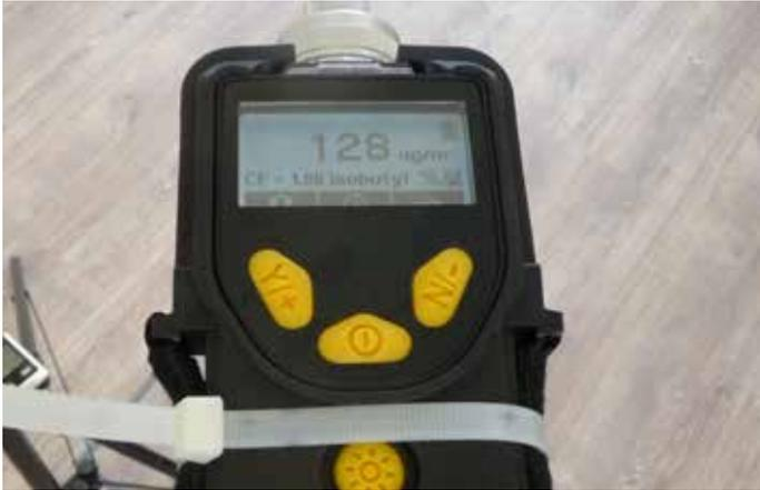
Messung der VOC-Belastung 28 Tage nach Fertigstellung der Oberflächen (Böden und Wände)
